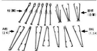
2 柱の頭部を起し柱と桁をならべる。
