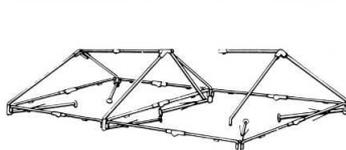
6 片方の柱を起して天幕をパイプに結びつけ、もう一方の柱を起しハスカイを固定する。
